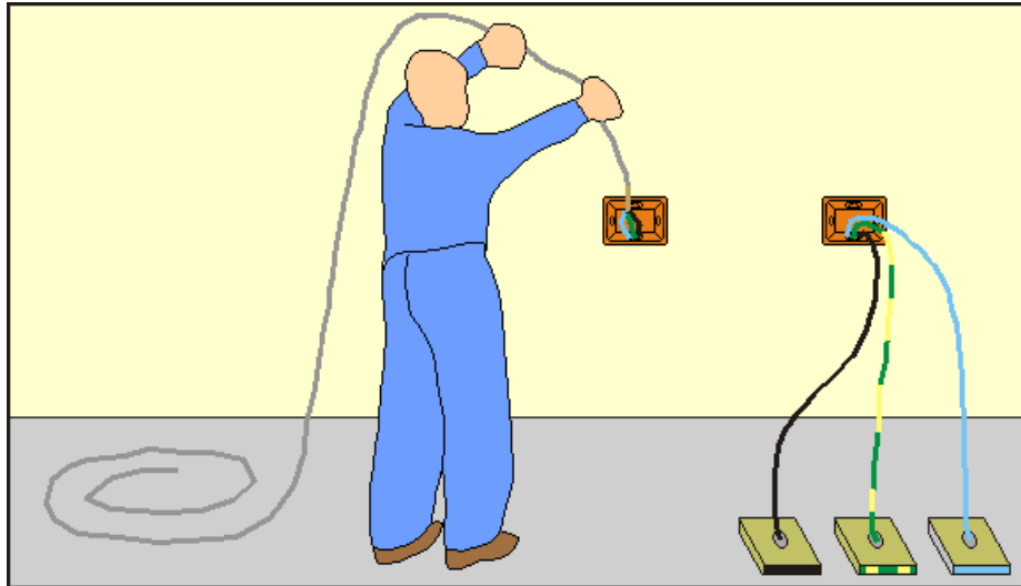
Fig. 1.6 - Infilaggio dei conduttori con l'ausilio di un'apposita sonda
